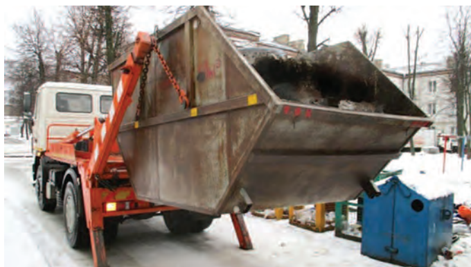
Рис. 7. Автомобиль, снабженный технологическим оборудованием в виде съемного контейнера
