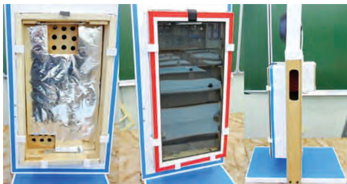
Действующая модель подогрева воздуха с использованием солнечной энергии в школьном кабинете физики
