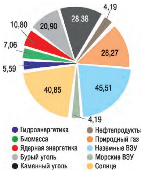
Чистая установленная мощность по выработке электроэнергии в Германии в 2016 году, ГВт
