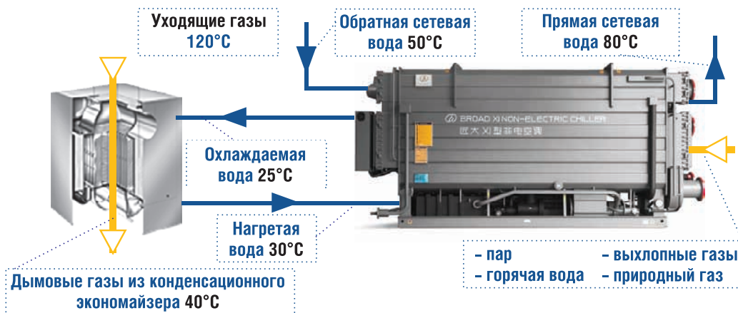
Рис. 2. Пример использования АБТН в комплекте с конденсационным экономайзером для охлаждения дымовых газов до 40°C и нагрева сетевой воды до 80°C
