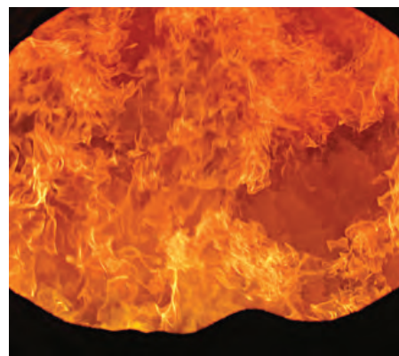
Рис. 3. Образец газификационного горения в топке «Calidum Ember». На правой стороне видны факелы вторичного горения газифицированного топлива в местах, где вдувается вторичный воздух. Газификационное горение позволяет распределить горение в большем объеме топки и этим предотвратить появление высоких температур пламени
