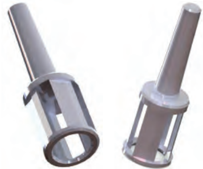
Рис. 5. Хвостовая фреза, обеспечивающая отвод стружки сквозь межзубую впадину
