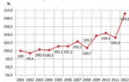
Рис 1. Динамика относительного изменения установленной электрической мощности тепловых электростанций
