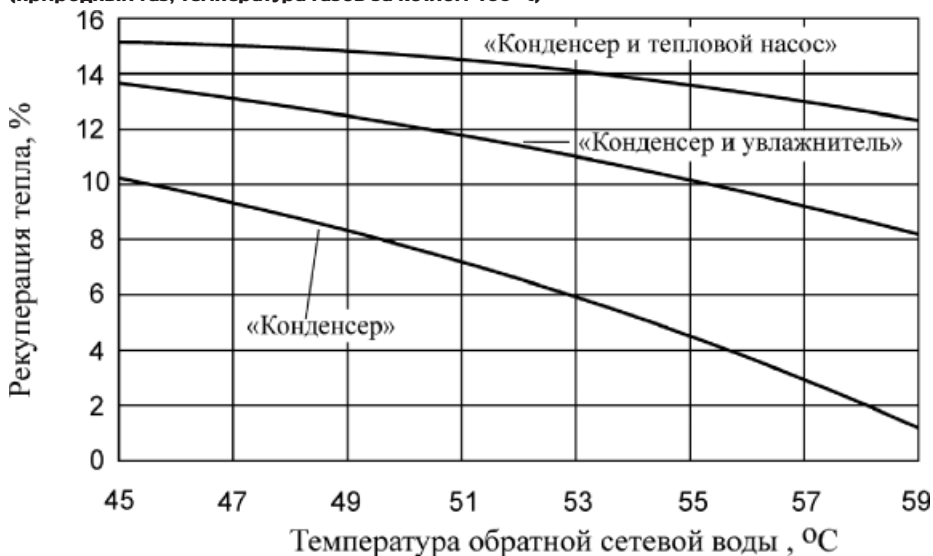
Рис. 1. Рекуперация тепла в зависимости от температуры обратной сетевой воды (природный газ, температура газов за котлом 135°C)
