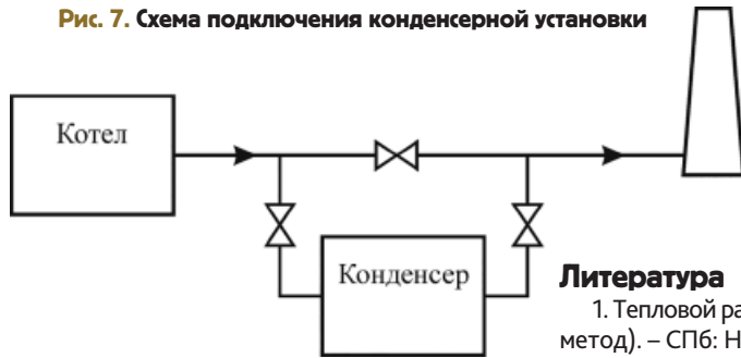
Рис. 7. Схема подключения конденсерной установки
