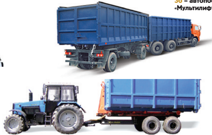
3в – полуприцеп контейнерный БЕЛАРУС ПК-12 для сбора и транспортировки щепы к энергоисточникам
