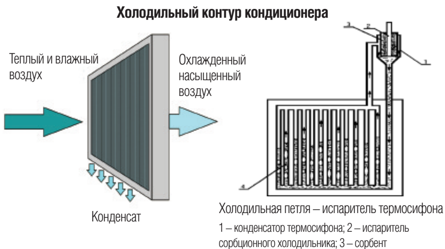
Рис. 4. Холодильная петля кондиционера расположена между охлаждающей (испаритель ПДТ) и подогревающей (конденсатор ПДТ) частями кондиционера
