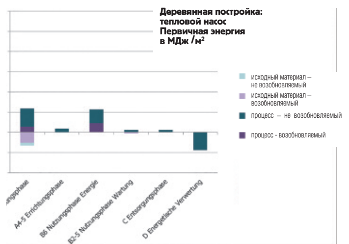
Рис. 5. Энергопотребление для здания с тепловым насосом
