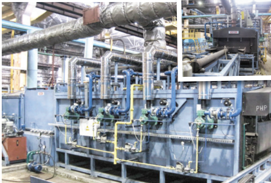
Модернизация закально-отпускной печи мод. 439-71 в термическом отделении кузнечного цеха РУП «Минский завод шестерен». Годовой экономический эффект 348 т у.т., или 74,8 тыс. $. Срок окупаемости 7,3 года
