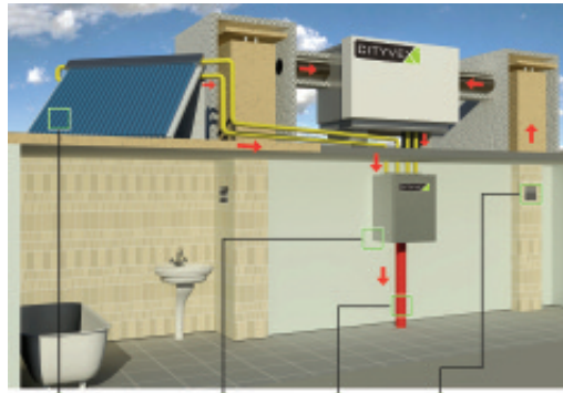
Солнечные коллекторы Тепловой насос Трубопровод Воздуховод
