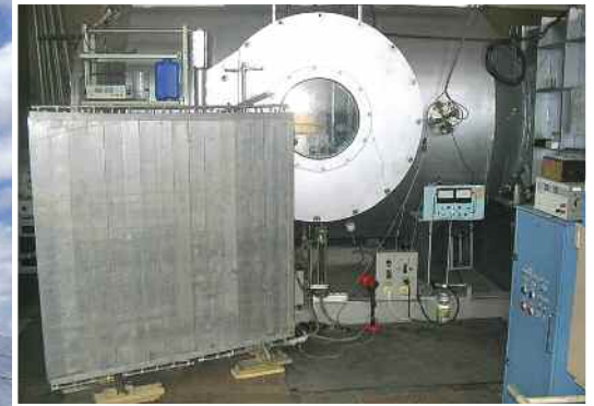
Рис. 8. Плоская алюминиевая панель: паровая камера + пародинамические термосифоны для охлаждения солнечных PV-коллекторов
