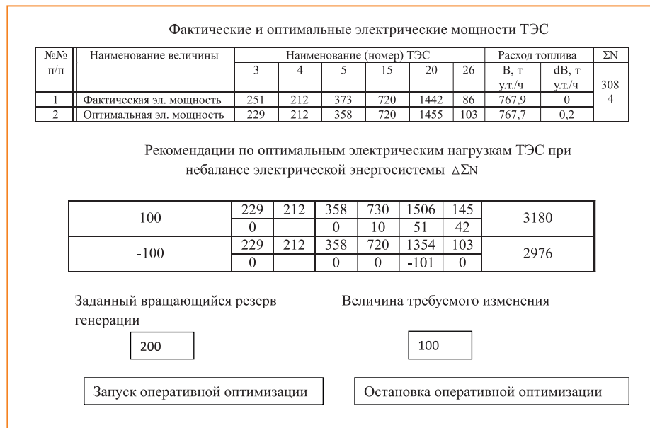
Рисунок 2. Вид главного окна программы оперативной оптимизации нагрузок ТЭС при окончании расчета
