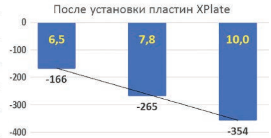
Рис. 6. Абсолютное снижение выбросов CO 2 в условиях 2021 года по котлу ДКВР-10/13 ст. № 3 [2]
