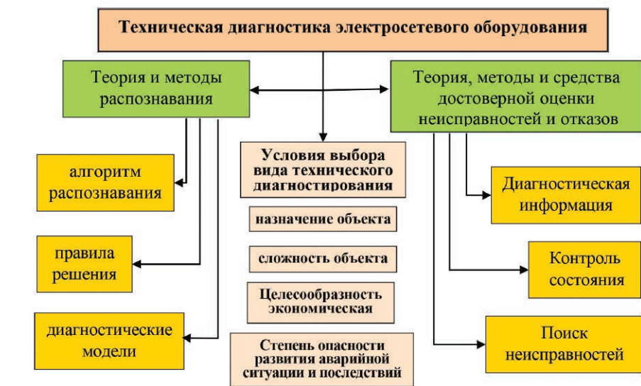
◆ Рис. 1. Структурная схема, обеспечивающая достоверную оценку технического состояния и раннее обнаружение неисправностей и отказов
