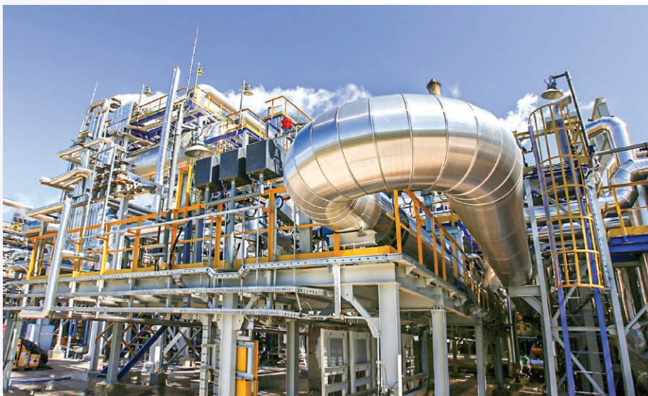
◆ ОАО «Нафтан»: установка производства элементарной серы методом Клауса
