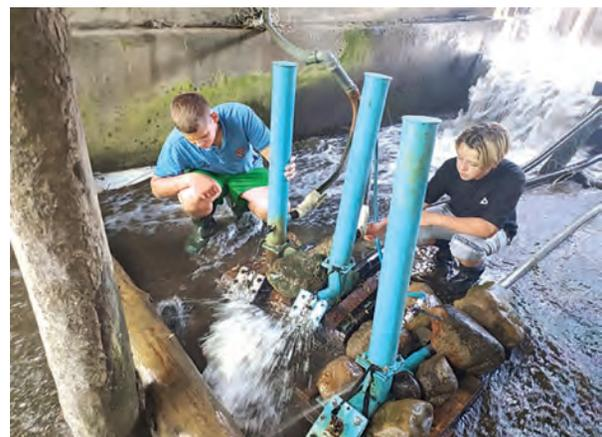
Рис. 10. Совместная работа трех насосов
