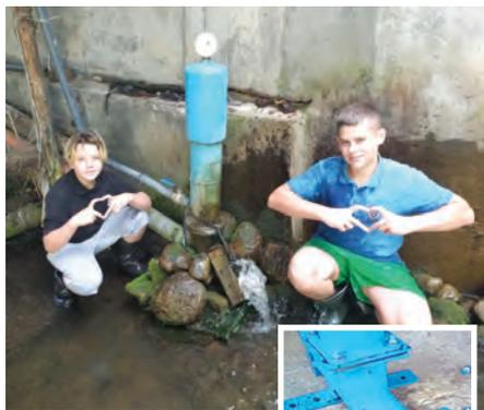
Рис. 8. Водяной насос с питающей трубой диаметром 90 мм
