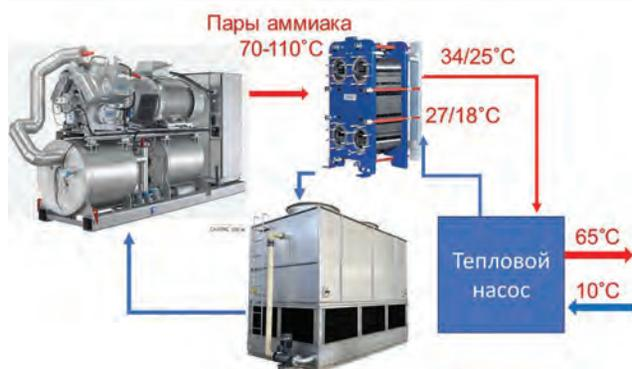
Рис. 3. Пример внедрения теплового насоса на мясоперерабатывающем заводе
