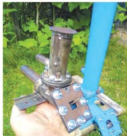
Рис. 9. Насосы 2 и 3 с питающей трубой диаметром 50 мм и 20 мм
