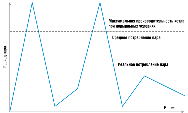
Рис. 2. Типичная диаграмма потребления пара при крупносерийном производстве
