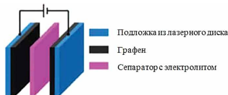
Схема графенового аккумулятора
