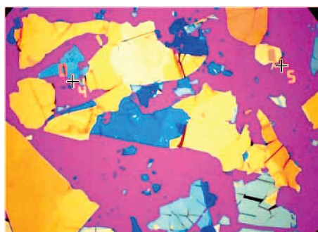
Графеновые чешуйки на поверхности пластины Si/SiO 2 от ~100 нм – бледно-желтые, 200 нм – голубые, 300 нм – фиолетовые
