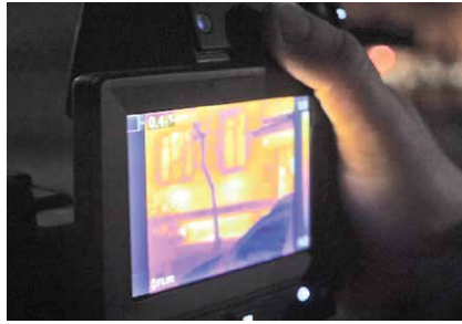
Старый дом слева: даже в условиях сравнительно теплой зимы на экране тепловизора видны теплотери (Минск, февраль 2020 г.). Справа – новый дом
