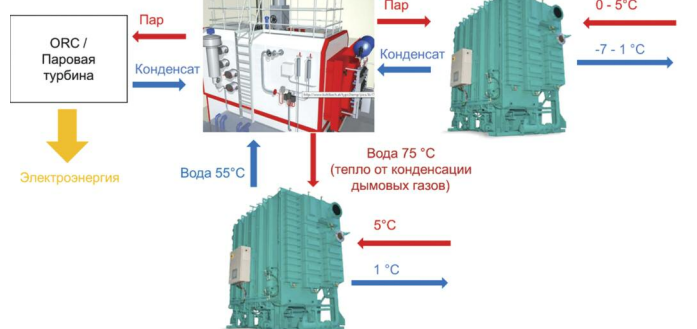
Рис. 7. Пример совместного использования АБХМ и паровых котлов на биомассе
