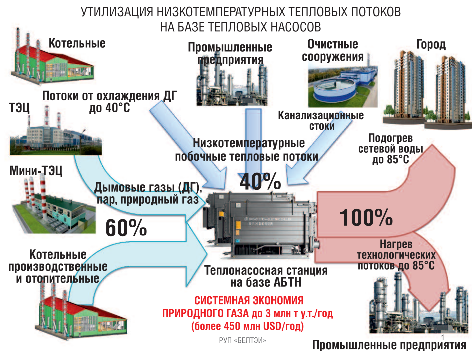
Рис. 9. Принципиальная схема теплоснабжения промышленных узлов с использованием тепловых ВЭР и ожидаемый эффект от ее реализации в Беларуси
