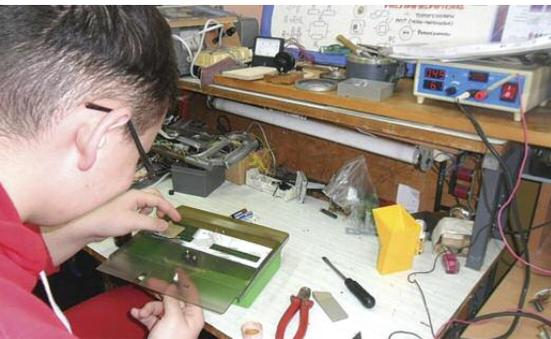
боты. Разрядное устройство, где находится очередная батарейка, передает энергию в накопительный аккумулятор, и после полной разрядки компаратор получает сигнал об этом.
