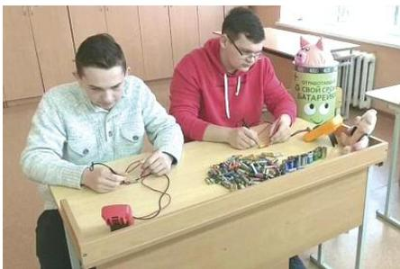
Такое устройство мы применяли для обнаружения батарей с остаточным напряжением не ниже 0,4 В. Из 100 батареек, взятых на исследование случайным образом, 63 батарейки оказались с остаточным напряжением, равным или более 0,5 В. Это составило 63% от исследуемой партии батареек. Таким образом, большая часть батареек подходит по параметрам для работы в схеме разрядки.
