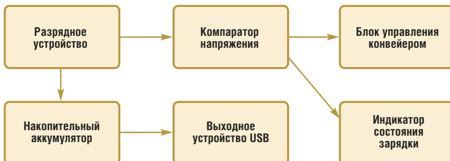
Далее включается исполнительный механизм, который выталкивает обработанную батарейку в контейнер для утилизации, а на ее место поступает следующая. Процесс постоянно повторяется. Выходное устройство служит для подключения потребителей USB 5 вольт. Блок индикации позволяет визуально следить за состоянием заряжаемого аккумулятора по свечению светодиода.
