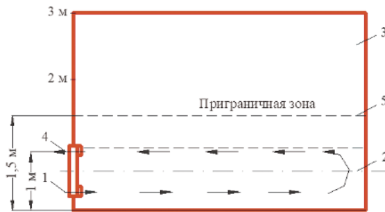
Рис. 2. Схема системы кондиционирования для осуществления способа распределения воздуха в помещении
