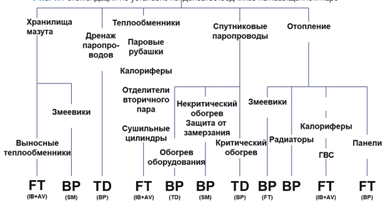
Рис. 1. Рекомендации по установке конденсатоотводчиков на насыщенном паре
