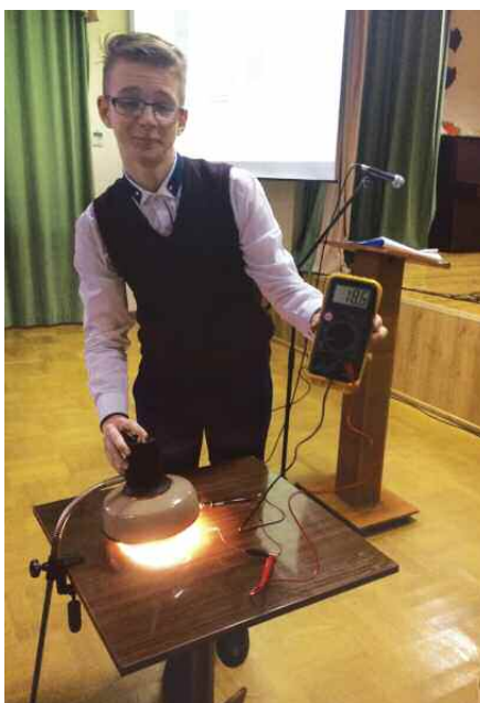
Рис. 14. Демонстрация работы фотоячейки на основе хлорида натрия и природного красителя на районном этапе конкурса «Энергомарафон-2017»
