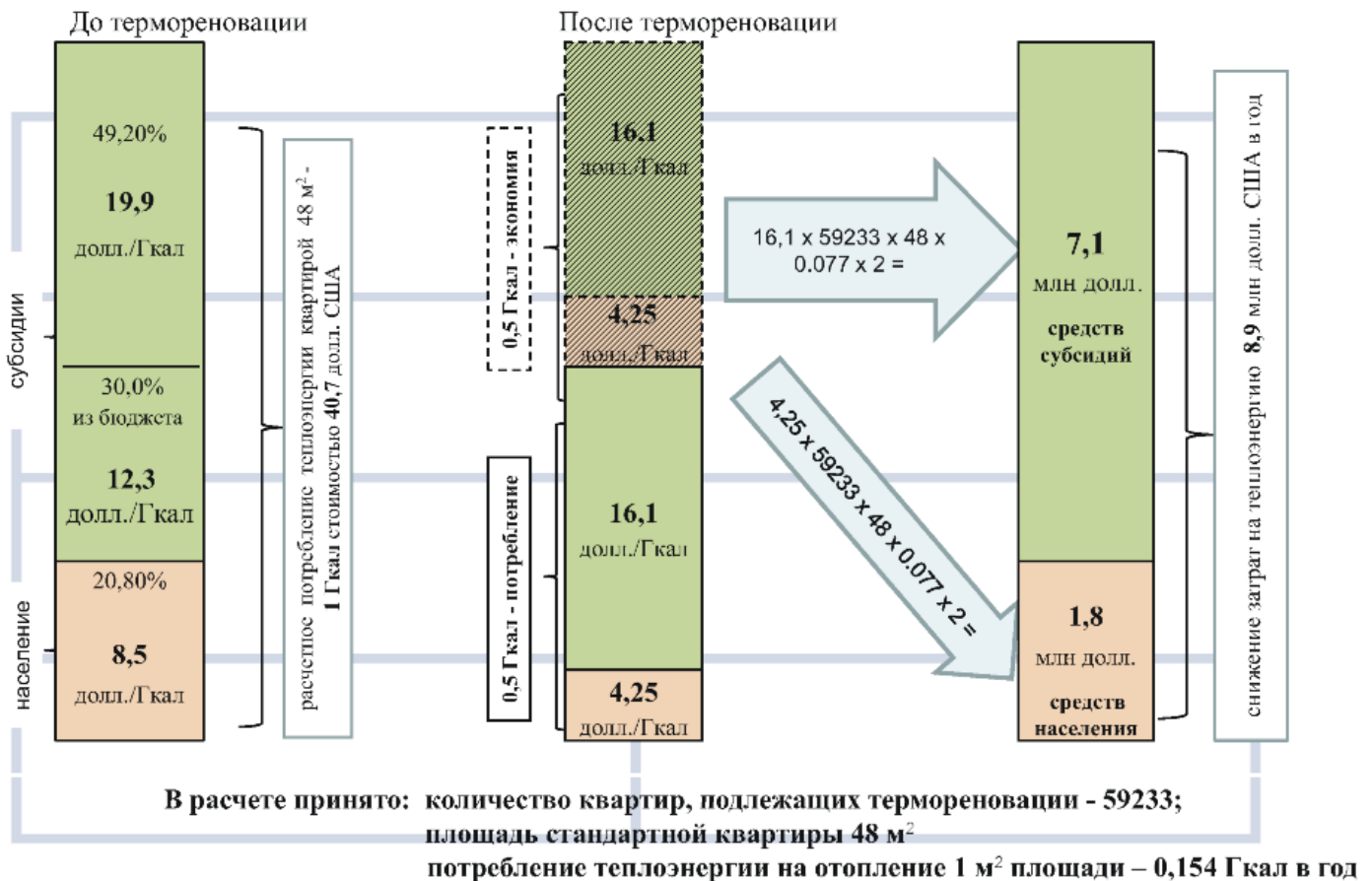
Рис. 4. Структура затрат на теплоэнергию до и после термомодернизации жилого помещения из наиболее энергозатратной части жилого фонда
