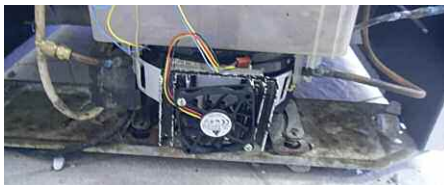
Фото 8. Крепление приставки на компрессор
