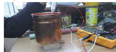
Фото 4. Термоэлектрогенератор Пельтье в работе со светодиодами
