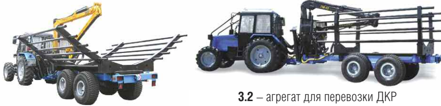
3.1 – агрегат для перевозки дровяной древесины
