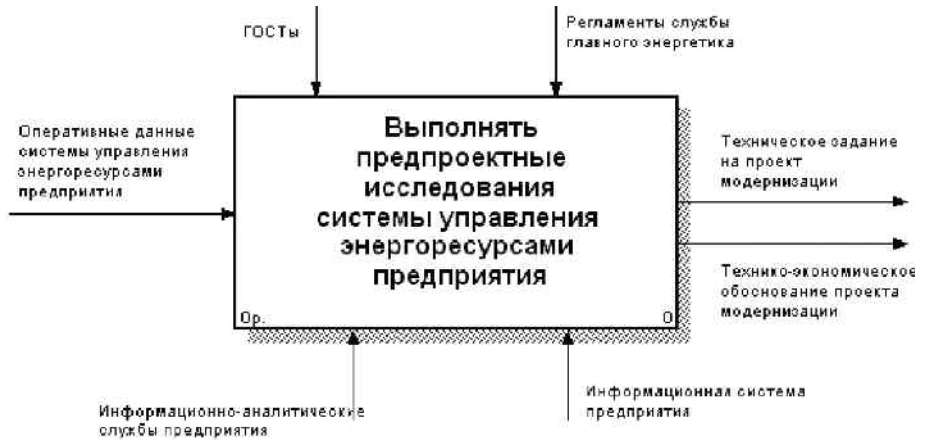
Рис. 3. Контекстная диаграмма бизнес-процесса предпроектных исследований в нотации структурно-функционального моделирования IDEF0
