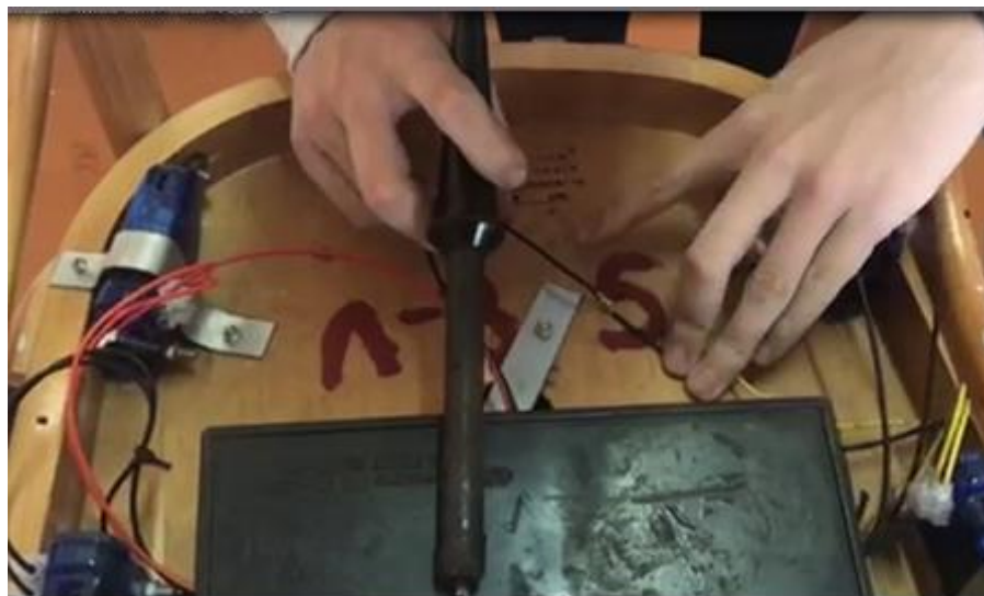
Рисунок 1. Монтаж элементов электрической схемы стула PowerBank
